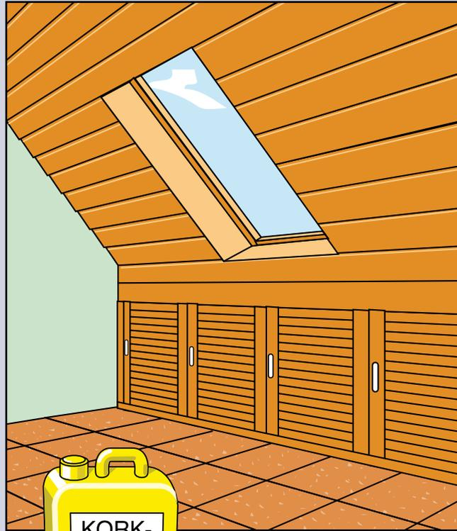
Etwa drei Tage nach der Verlegung kann die Oberfläche des naturbelassenen Korkparketts versiegelt werden. Sie kann auch gewachst oder imprägniert werden. Den haltbarsten Schutz bietet jedoch die Versiegelung. Bei der Ver-
